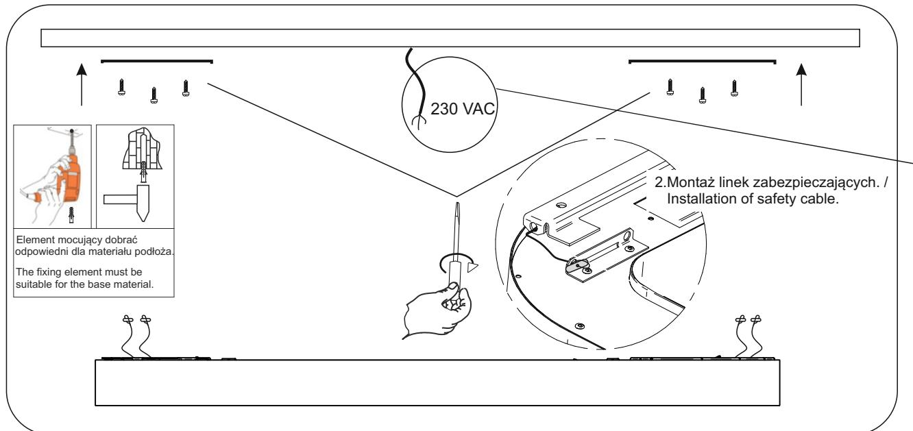
2. Montaż linek zabezpieczających. / Installation of safety cable.
